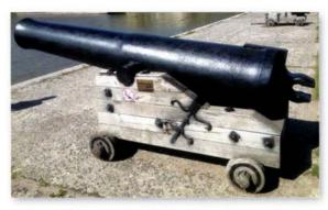
36-фунтовое (калибр – 173 мм.) гладкоствольное бомбовое орудие.
